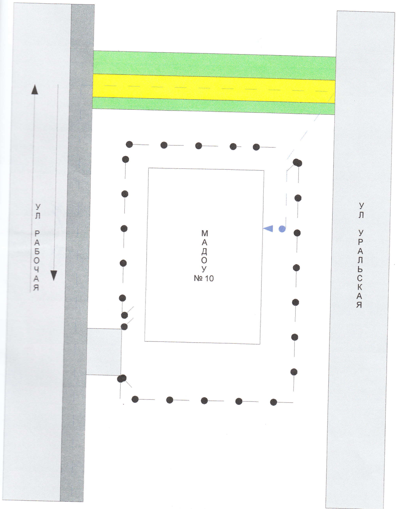
План – схема пути движения транспортных средств и детей при проведении ремонтно-строительных работ вблизи образовательного учреждения
